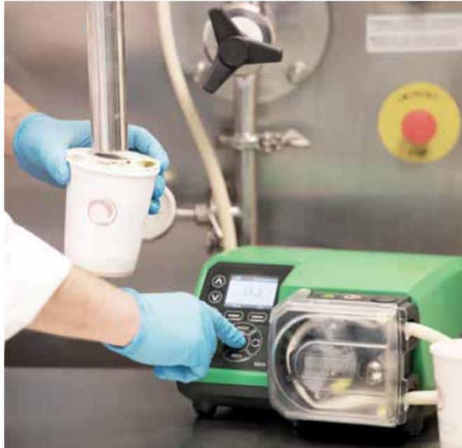
Las bombas peristálticas pueden manejar fluidos agresivos y sensibles al cizallamiento. El fluido bombeado queda completamente contenido dentro de la manguera, aislándolo por completo y evitando la contaminación cruzada.
