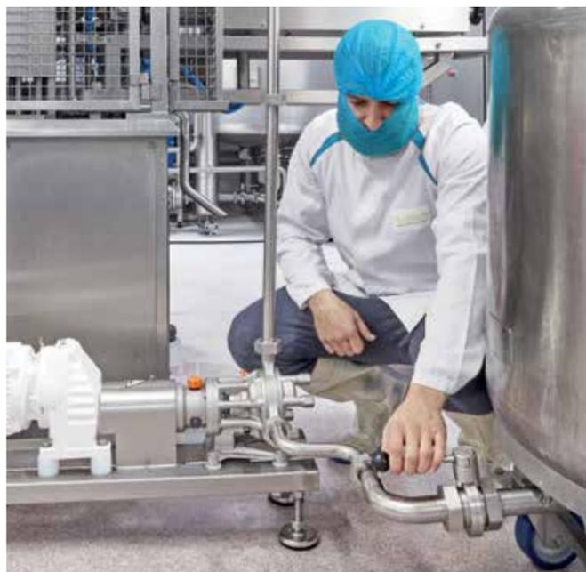
Certa de MasoSine supera el rendimiento de las bombas lobulares en aplicaciones críticas de alimentos y bebidas. El diseño del rotor sinusoidal de nuestras bombas MasoSine proporciona una suave acción de bombeo con un menor cizallamiento para la transferencia de productos alimenticios delicados sin riesgo de degradación.
