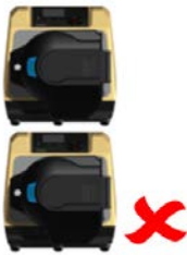
Figura 4 - Empilhamento de bombas
