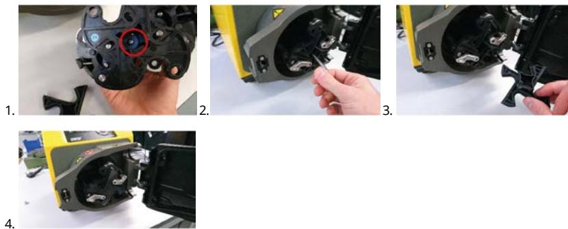
确保已安装转子隔圈。
