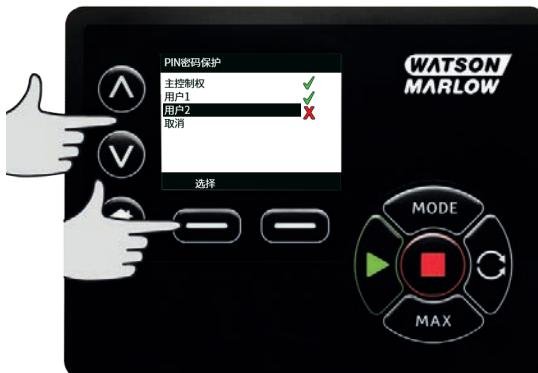
启用用户 2 的安全设置将显示用户 2 的 PIN 密码输入屏幕。若需定义用户 2 的四位数字 PIN 密码，使用  $\wedge/\vee$  键选择每位数字(从 0 到 9)。一旦完成当前位的数字，按下 **NEXT DIGIT(下一位数字)** 键。选择第四位数字后，按下 **ENTER**。
