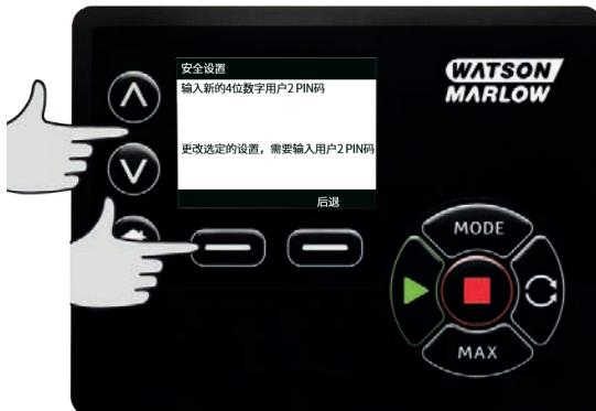
如需定义允许的功能，使用  $\wedge/\vee$  键选择所需功能，接着按下 **启用**。用户 2 的 PIN 密码仅允许访问已启用的功能，如需禁用功能，请选中已启用的功能，接着按下 **禁用**。已启用所有所需功能时，按下 **完成**。
