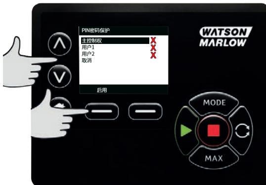
启用用户 1 的安全设置将显示用户 1 的 PIN 密码输入屏幕。若需定义用户 1 的四位数字 PIN 密码，使用  $\wedge/\vee$  键选择每位数字(从 0 到 9)。一旦完成当前位的数字，按下 **NEXT DIGIT(下一位数字)** 键。选择第四位数字后，按下 **ENTER**。
