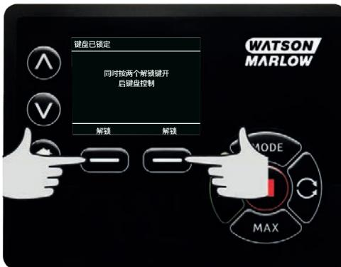
操作模式主屏幕上将显示一个挂锁图标，表示已激活键盘锁。
