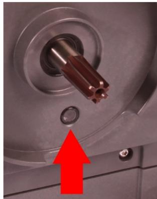
Certifique-se de que o sensor de detecção de vazamento e o eixo do acionamento estão limpos e livres de produtos químicos do processo. Se encontrar qualquer evidência de resíduos químicos, desconecte a bomba da rede elétrica e contate o representante local da Watson-Marlow.
