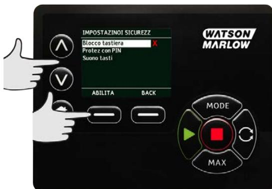
Una volta bloccata apparirà la schermata seguente ogni volta che viene premuto un tasto. Per sbloccare la tastiera premere contemporaneamente i due tasti di **SBLOCCAGGIO**.
