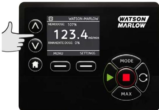
Se si preme **STOP** durante il dosaggio, la pompa si arresta. Premendo **START** la dose interrotta riprende o viene abbandonata a seconda delle impostazioni in "Riprendere le dosi interrotte" a pagina 36.
