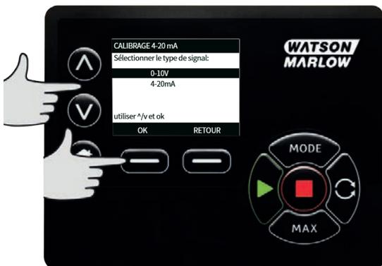
La pompe permet de saisir les signaux minimum et maximum en mA ou V de deux façons: manuellement ou via l'entrée analogique. La procédure de saisie des valeurs mA décrite ici est identique à la procédure de saisie des signaux de tension V.
