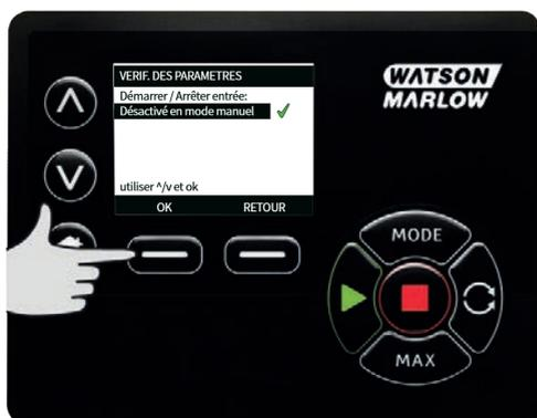
À l'aide des touches  $\wedge/\vee$ , indiquez l'état logique de l'entrée sélectionnée pour votre matériel de commande connecté, puis appuyez sur **SÉLECTIONNER**
