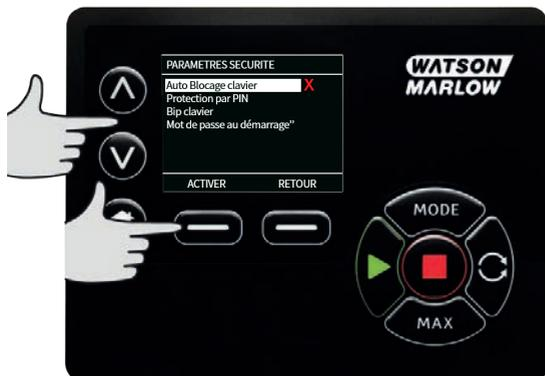
Une fois le clavier verrouillé, le message ci-dessous s'affiche lorsque vous appuyez sur une touche. Pour déverrouiller le clavier, appuyez sur les deux touches **DÉVERROUILLER** simultanément.
