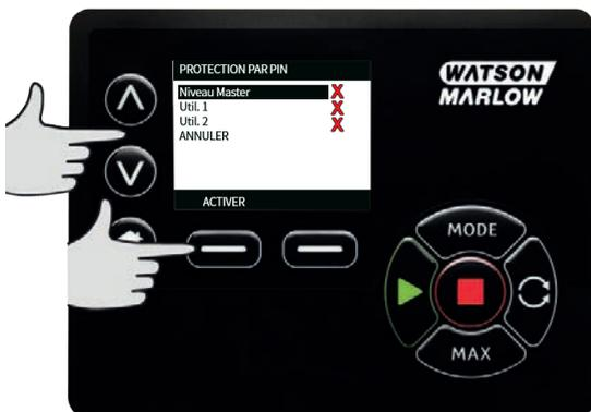
Pour configurer le code PIN Maître à quatre chiffres, utilisez les touches  $\wedge$  /  $\vee$  afin de sélectionner chaque chiffre compris entre 0 et 9. Une fois le chiffre désiré affiché à l'écran, appuyez sur **CHIFFRE SUIVANT**. Une fois les quatre chiffres sélectionnés, appuyez sur **ENTRÉE**.
