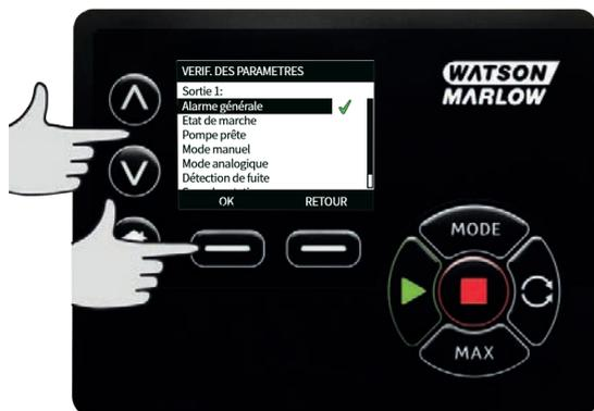
À l'aide des touches  $\wedge$  /  $\vee$ , indiquez l'état logique de la sortie sélectionnée, puis appuyez sur **SÉLECTIONNER**.
