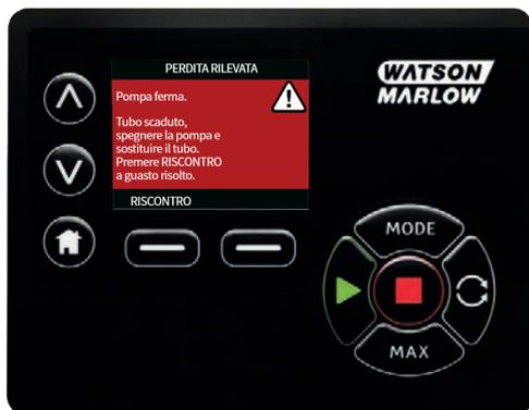
Attenersi alle istruzioni riportate in "Sostituzione del tubo " a pagina120 per sostituire il tubo o l'elemento tubo.
