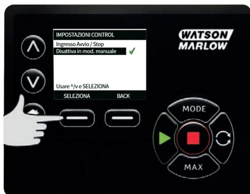
Usare i tasti  $\wedge$  /  $\vee$  e premere **SELEZIONA** per scegliere lo stato di logica per l'input selezionato per l'hardware di comando collegato.
