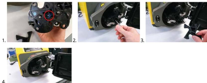
Verificare che sia ancora installato il distanziatore del mozzo rotore.
