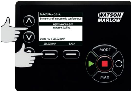
Selezionare il tipo di segnale di input usando i tasti  $\wedge$  /  $\vee$  e premere **SELEZIONA**.
