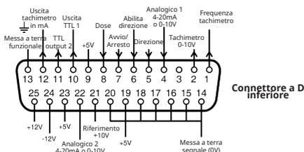
Il connettore da 0 V di questa pompa è isolato in CC (flottante) dalla messa a terra delle rete di alimentazione della pompa. Tuttavia, va evitato che i connettori da 0 V della pompa superino 10 V dalla messa a terra della rete di alimentazione della pompa tramite la connessione con apparecchiature remote, per evitare di sottoporre a sollecitazioni eccessive i connettori da 0 V interni ai condensatori EMI della massa.
