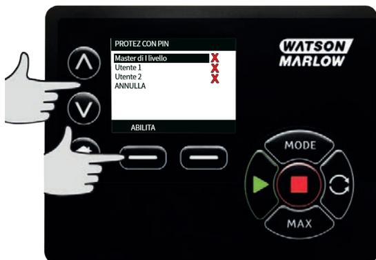
ABILITA le impostazioni di sicurezza per l'Utente 1 visualizza la schermata di inserimento del PIN per l'Utente 1. Per definire un PIN a quattro cifre per l'Utente 1, usare i tasti  $\wedge$  /  $\vee$  per selezionare ogni cifra da 0 a 9. Una volta raggiunta la cifra desiderata, premere il tasto **CIFRA SUCCESSIVA**. Dopo aver selezionato la quarta cifra premere **INVIO**.
