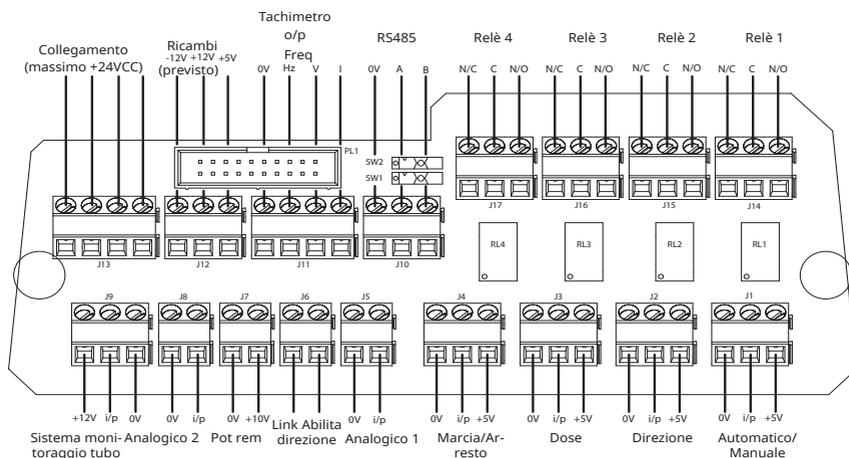
Nota: Si raccomanda di separare il modulo dalla pompa e lasciare il connettore PCB fissato al retro della pompa. Scollegare il cavo a nastro del modulo dalla pompa utilizzando le levette di espulsione sulla scheda del connettore.
