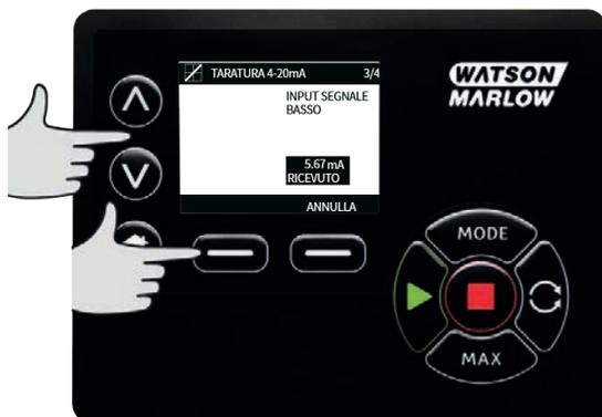
Se l'intervallo tra il segnale basso e quello alto è inferiore a 1.5mA, verrà visualizzato il messaggio d'errore seguente.
