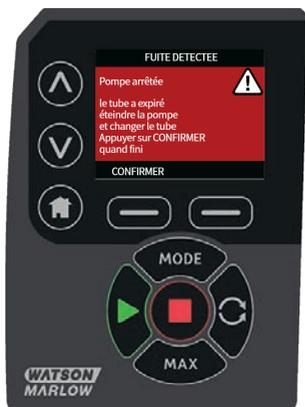
Suivez les consignes énoncées à la section « Remplacement des tubes » sur la page 114 pour remplacer le tube ou l'élément du tube.
