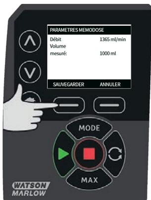
Lorsque les paramètres de MemoDose sont configurés, l'écran suivant s'affiche ; appuyez sur **MEMODOSE** pour ouvrir le mode MemoDose ou sur **RETOUR** pour revenir à l'écran Paramètres MemoDose.
