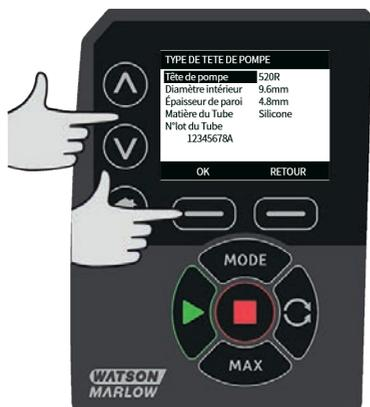
À l'aide des touches  $\wedge$  /  $\vee$ , placez la barre de sélection sur le type de tête de pompe désiré, puis appuyez sur **SÉLECTIONNER**.
