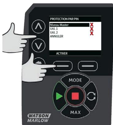
Pour configurer le code PIN Maître à quatre chiffres, utilisez les touches  $\wedge$   $\vee$  afin de sélectionner chaque chiffre compris entre 0 et 9. Une fois le chiffre désiré affiché à l'écran, appuyez sur **CHIFFRE SUIVANT**. Une fois les quatre chiffres sélectionnés, appuyez sur **ENTRÉE**.
