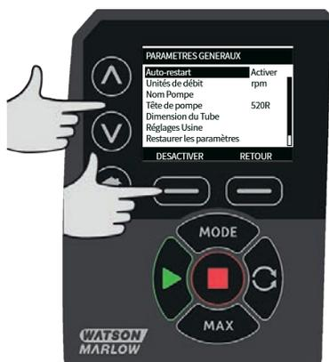
À l'aide des touches  $\wedge$  /  $\vee$ , placez la barre de sélection sur **Tête de pompe**, puis appuyez sur **SÉLECTIONNER**.
