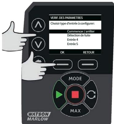
La valeur par défaut est ✖. L'entrée démarrage/arrêt n'est pas désactivée en mode manuel. Appuyez sur **SÉLECTIONNER** pour modifier le paramètre sur ✓.
