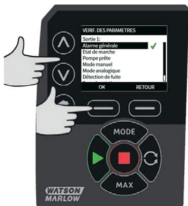
À l'aide des touches  $\wedge$  /  $\vee$ , indiquez l'état logique de la sortie sélectionnée, puis appuyez sur **SÉLECTIONNER**.
