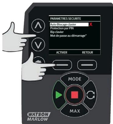
Une fois le clavier verrouillé, le message ci-dessous s'affiche lorsque vous appuyez sur une touche. Pour déverrouiller le clavier, appuyez sur les deux touches **DÉVERROUILLER** simultanément.
