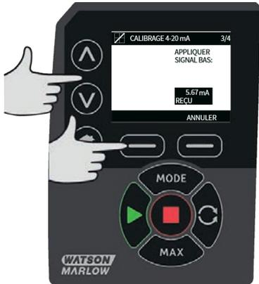
Si la plage entre le signal minimum et le signal maximum est inférieure à 1,5 mA, le message d'erreur suivant s'affiche à l'écran.
