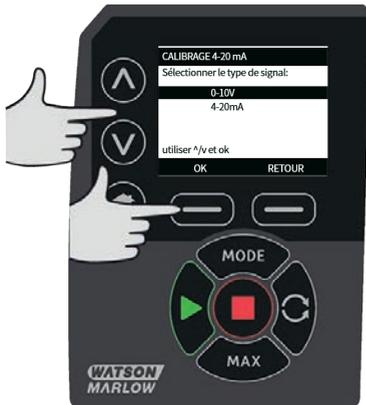
La pompe permet de saisir les signaux minimum et maximum en mA ou V de deux façons : manuellement ou via l'entrée analogique. La procédure de saisie des valeurs mA décrite ici est identique à la procédure de saisie des signaux de tension V.
