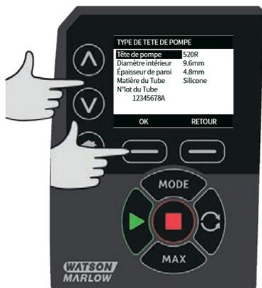
À l'aide des touches  $\wedge$  /  $\vee$ , placez la barre de sélection sur la taille de tube à utiliser, puis appuyez sur **SÉLECTIONNER**.
