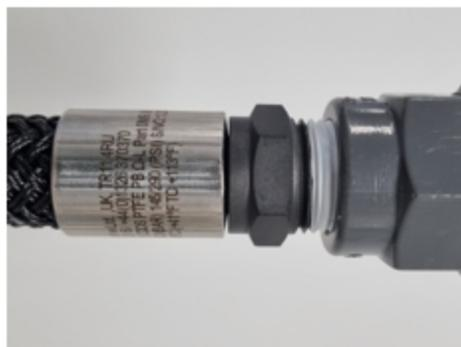
4. Verifique que esté colocado el sello del puerto del cabezal, como se observa en la imagen, y que no esté dañado.
