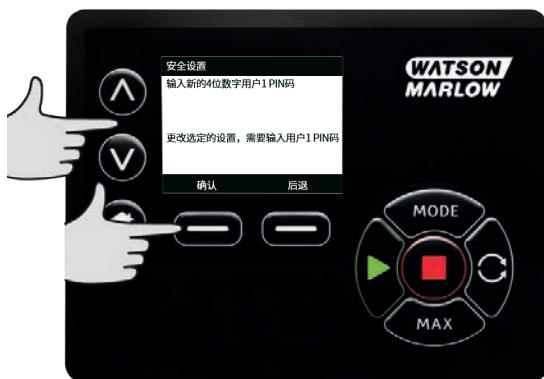
现在按下 **CONFIRM(确认)** 检查输入的号码是否是您需要的 PIN 密码。按下 **CHANGE(更改)** 返回 PIN 密码输入界面。
