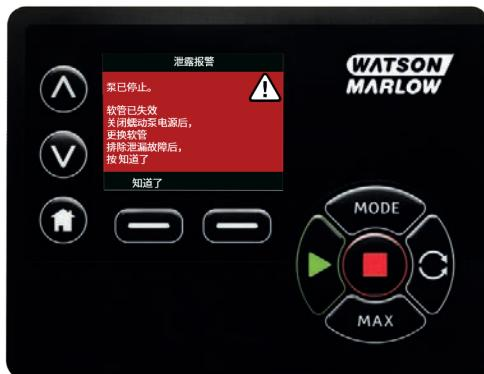
请遵循“软管更换”[页码 110]的说明来更换软管或软管单元。
