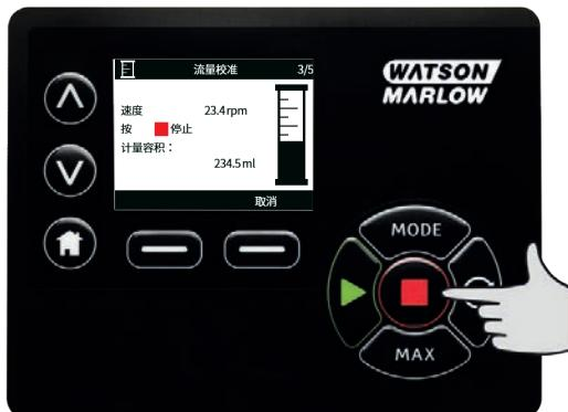
使用  $\wedge/\vee$  键输入实际泵送的流体体积。
