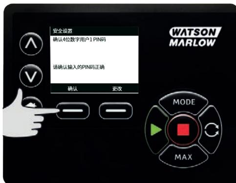
如需定义允许的功能，使用 **↑/↓** 键选择所需功能，接着按下 **启用**。用户 1 的 PIN 密码仅允许访问已启用的功能，如需禁用功能，请选中已启用的功能，接着按下 **禁用**。已启用所有所需功能时，按下 **完成**。
