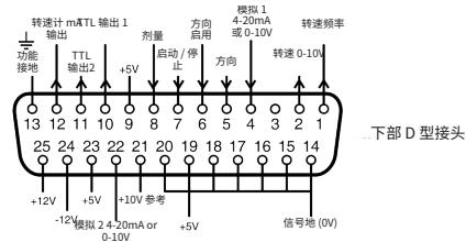
本泵的0V与电源地线直流隔离(浮接)。并注意与远程设备相连的0V同主电源地线之间的压差不得超过10V，否则将超出内部0V与接地之间的抗干扰能力。
