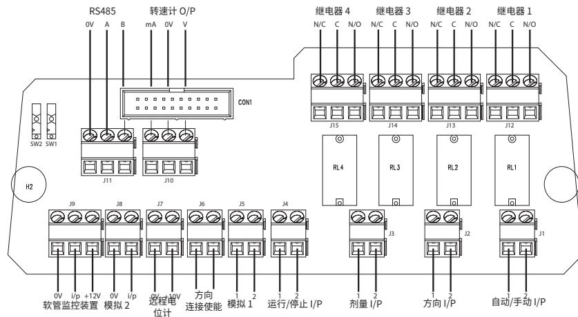
推荐控制电缆：公制 = 0.14-2.5sqmm( 单股线 ) 或 0.14-1.5sqmm( 多股线 )。英制 = 26-14AWG( 单股线 ) 或 26-16AWG( 多股线 )。电缆截面：圆形。确认穿过标准格兰头的最大 / 最小外径：9.5-5mm。电缆截面必须为圆形，以确保密封。
