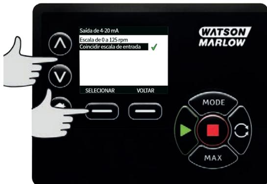
Use as teclas  $\wedge$  /  $\vee$  e pressione **SELECT** para selecionar a configuração necessária:
