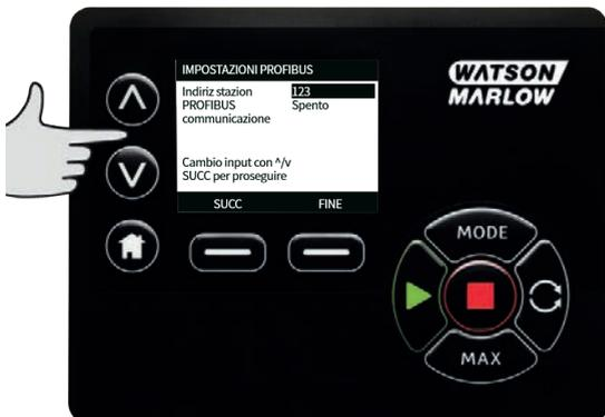
Usare i tasti  $\wedge$  e  $\vee$  per attivare o disattivare la comunicazione PROFIBUS e premere **TERMINA**.
