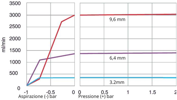
**Elemento Sta-Pure, 0-2 bar (0-30 psi), 200 giri/min, rotazione in senso antiorario**
