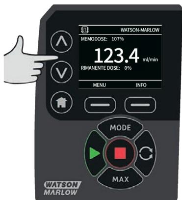
Se si preme **STOP** durante il dosaggio, la pompa si arresta. Premendo **START** la dose interrotta riprende o viene abbandonata a seconda delle impostazioni in "Riprendere le dosi interrotte" a pagina 76.
