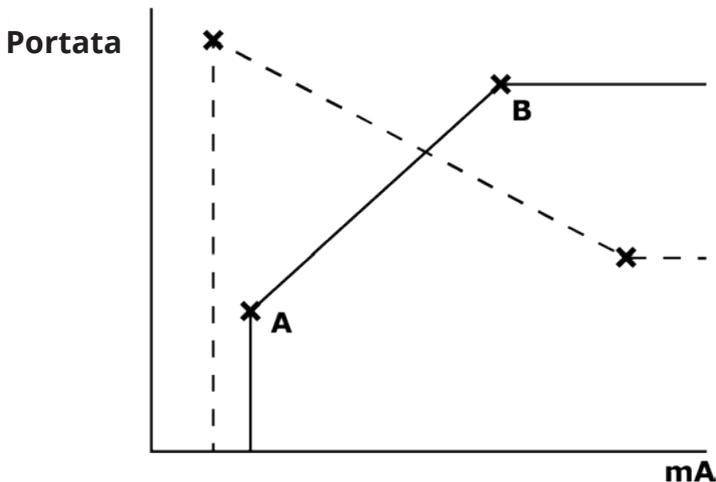
Quando il segnale analogico ricevuto è superiore al livello definito dal punto A, l'output di funzionamento sarà alimentato quando la pompa è in funzione.
