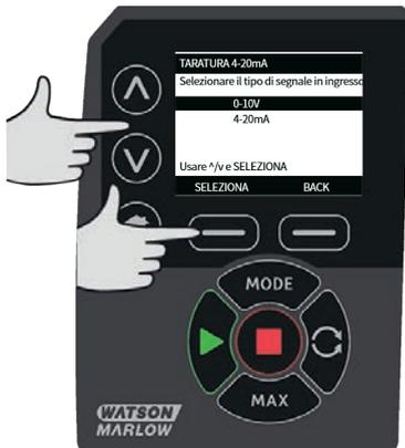
La pompa offre l'opzione di inserire manualmente il segnale mA o V alto e basso o tramite l'input analogico. L'inserimento dei segnali mA è descritto qui, tuttavia il processo per inserire i segnali V è identico.
