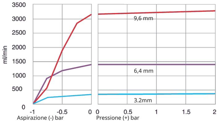
**Elemento Marprene TM, 2-4 bar (20-30 psi), 200 giri/min, rotazione in senso antiorario**
