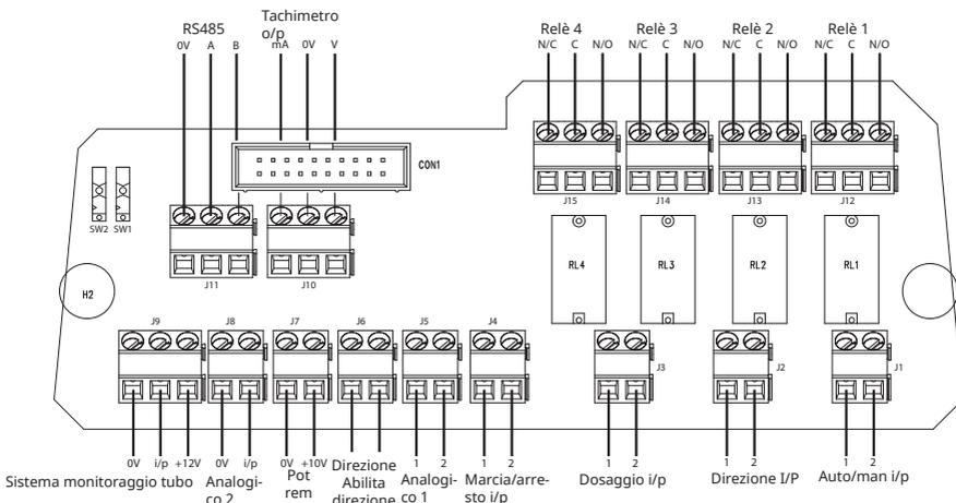
Cavo di comando consigliato: sistema metrico decimale = 0.14-2.5 mm<sup>2</sup> (conduttore unico) e 0.14-1.5 mm<sup>2</sup> (più conduttori). USA = 26-14 AWG (anima piena) e 26-16 AWG (intrecciato). Cavo: circolare. Diametro esterno max/min per assicurare la tenuta quando viene passato attraverso la guarnizione standard: 9,5-5 mm. **La sezione del cavo deve essere circolare per garantire la tenuta.**
