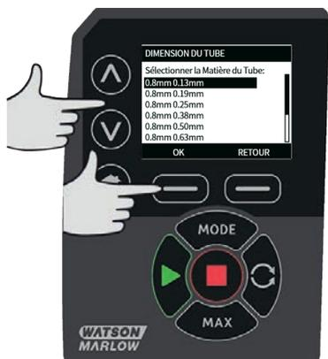
Si un élément LoadSure a été sélectionné, la taille du tube apparaît en guise de pression et de diamètre intérieur.
