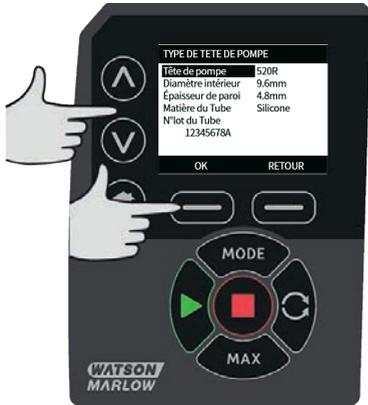
À l'aide des touches  $\wedge$  /  $\vee$ , placez la barre de sélection sur le matériau du tube à utiliser, puis appuyez sur **SÉLECTIONNER**.
