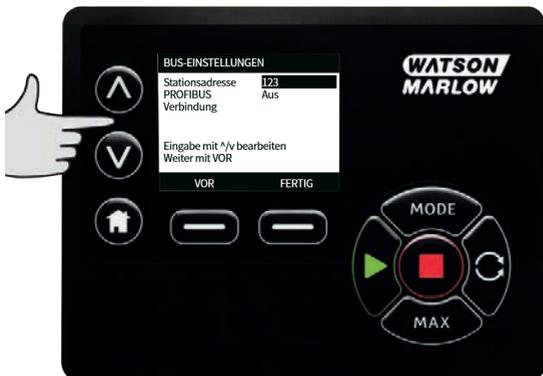
Über die  $\wedge$  und  $\vee$  Tasten die PROFIBUS Kommunikation aktivieren bzw. deaktivieren und auf **FERTIG** drücken.
