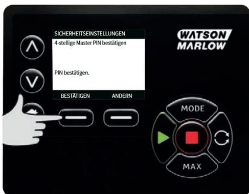
Zur Bestätigung, dass die Master-PIN für den Zugriff auf alle Funktion eingerichtet worden ist, erscheint folgender Bildschirm. Auf **VOR** drücken, um bestimmte Funktionen für den Zugriff durch Benutzer 1 und Benutzer 2 zu aktivieren.
