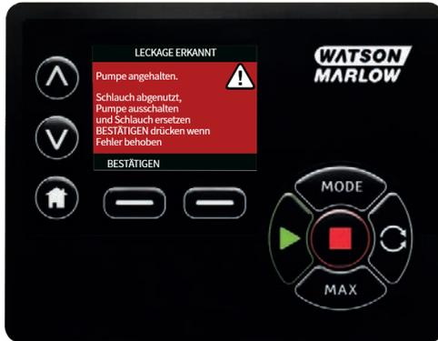
Anweisungen auf Seite 1 unter "Schlauch auswechseln " auf Seite 91 zum Wechseln des Schlauches oder Schlauchelementes beachten.
