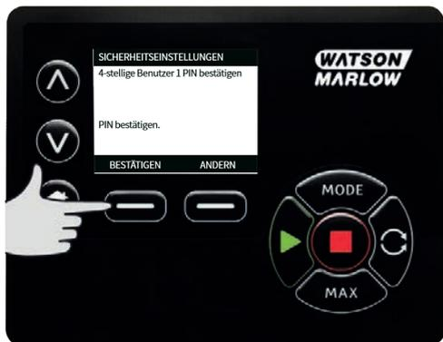
Über die  $\wedge$  /  $\vee$  Tasten die zuzuordnenden Funktionen bestimmen und mit **AKTIVIEREN** bestätigen. Mit der PIN des Benutzers 1 ist ein Zugriff nur auf die zugeordneten Funktionen möglich. Zur Deaktivierung die aktivierten Funktionen markieren und auf **DEAKTIVIEREN** drücken. Nach Aktivierung aller benötigten Funktionen auf **FERTIG** drücken.
