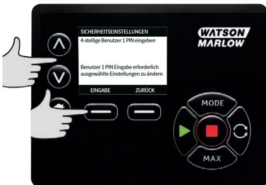
Anschließend zur Überprüfung der PIN auf **BESTÄTIGEN** drücken. Auf **ÄNDERN** drücken, um zur PIN-Eingabe zurückzugehen.
