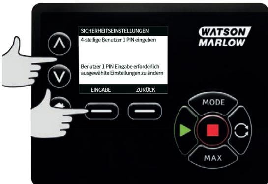
Abschließend zur Überprüfung der PIN auf **BESTÄTIGEN** drücken. Auf **ÄNDERN** drücken, um zur PIN-Eingabe zurückzugehen.
