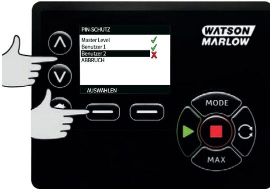
Über Sicherheitseinstellungen Benutzer 2 **AKTIVIEREN** wird der PIN-Eingabebildschirm für Benutzer 2 aufgerufen. Über die Tasten  $\wedge$   $\vee$  eine vierstellige PIN aus den Ziffern 0-9 für Benutzer 2 eingeben. Nach Eingabe einer Ziffer auf **NÄCHSTE ZIFFER** drücken. Nach der vierten Ziffer auf **EINGABE** drücken.
