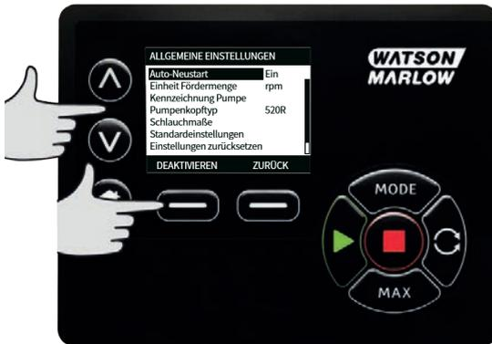
Über die  $\wedge$ / $\vee$  Tasten den Auswahlbalken auf **Pumpenkopftyp** bewegen und auf **AUSWÄHLEN** drücken.
