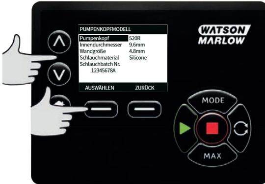
Über die  $\wedge$  /  $\vee$  Tasten den Auswahlbalken auf den gewünschten Schlauchwerkstoff bewegen und auf **AUSWÄHLEN** drücken.
