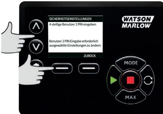
Über die  $\wedge$  /  $\vee$  Tasten die zuzuordnenden Funktionen bestimmen und mit **AKTIVIEREN** bestätigen. Mit der PIN des Benutzers 2 ist ein Zugriff nur auf die zugeordneten Funktionen möglich. Zur Deaktivierung die aktivierten Funktionen markieren und auf **DEAKTIVIEREN** drücken. Nach Aktivierung aller benötigten Funktionen auf **FERTIG** drücken.
