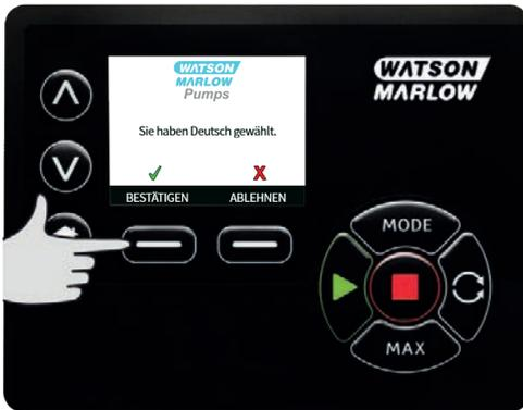
3. Mit **ABLEHNEN** können Sie zum Menü Sprachauswahl zurückgehen. Anschließend kehren Sie zur Ausgangsseite zurück.
