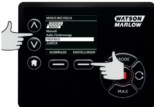
Über die  $\wedge$  und  $\vee$  Tasten kann die Stationsadresse in einem Bereich von 1 bis 125 geändert werden (126 ist die standardmäßige Stationsadresse). Auf **FERTIG** drücken, um die Stationsadresse einzustellen, oder auf **WEITER**, um die PROFIBUS Kommunikation zu aktivieren/deaktivieren.
