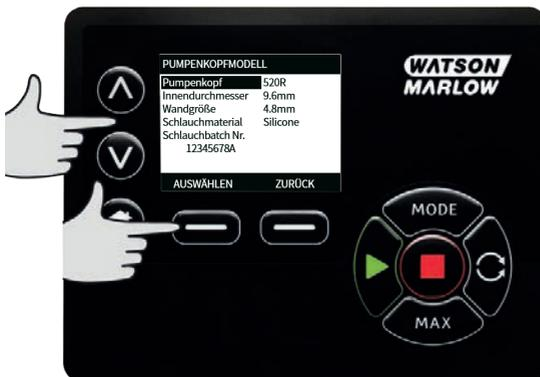
Über die  $\wedge$  /  $\vee$  Tasten den Auswahlbalken auf den gewünschten Pumpenkopf bewegen und auf **AUSWÄHLEN** drücken.
