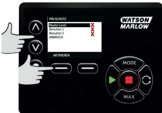
Über die Tasten  $\wedge$  /  $\vee$  eine vierstellige Master-PIN aus den Ziffern 0-9 eingeben. Nach Eingabe einer Ziffer auf **NÄCHSTE ZIFFER** drücken. Nach der vierten Ziffer auf **EINGABE** drücken.
