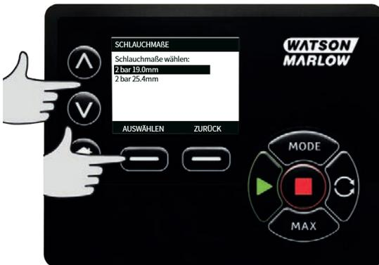
In diesem Bildschirm kann ebenfalls ein Werkstoff für den eingesetzten Schlauch bestimmt werden.
