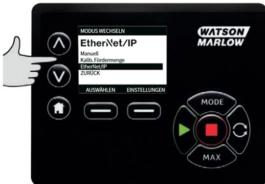
3. Drücken Sie die Taste **AUSWÄHLEN**, um die Betriebsart **EtherNet/IP™** zu verwenden.
