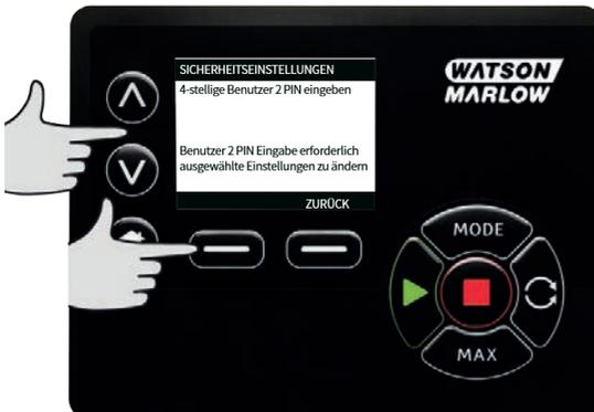
3. Über  $\wedge$  /  $\vee$  die zuzuordnenden Funktionen bestimmen und mit **AKTIVIEREN** bestätigen. Mit der PIN des Benutzers 2 ist ein Zugriff nur auf die zugeordneten Funktionen möglich. Zur Deaktivierung die aktivierten Funktionen markieren und auf **DEAKTIVIEREN** drücken. Nach Aktivierung aller benötigten Funktionen auf **FERTIG** drücken.
