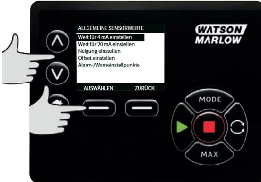
11. Ändern Sie mit  $\wedge/\vee$  den Wert, der angezeigt wird, wenn der Sensoreingang bei 20 mA liegt. Wenn Sie mit dem Wert zufrieden sind, drücken Sie **AUSWÄHLEN**.
