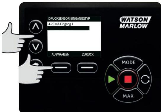
6. Markieren Sie mit  $\wedge$  /  $\vee$  den gewünschten Durchflusssensor und drücken Sie **AUSWÄHLEN**.
