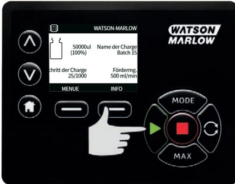
Startet die Pumpe, und der Hintergrund des Displays wird grau. Hat keine Auswirkung, wenn die Pumpe bereits in Betrieb ist.
