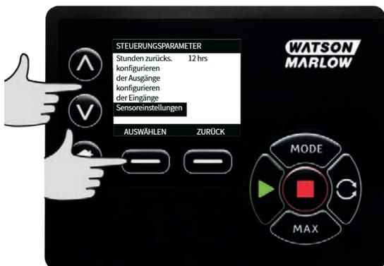
2. Markieren Sie im Menü Steuerungseinstellungen mit  $\wedge$  /  $\vee$  die Option **Sensorverzögerung einstellen** und drücken Sie **AUSWÄHLEN**.
