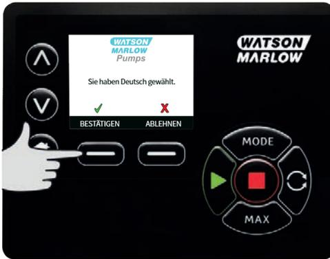
3. Mit **ABLEHNEN** können Sie zum Menü Sprachauswahl zurückkehren. Anschließend kehren Sie zur Ausgangsseite zurück.
