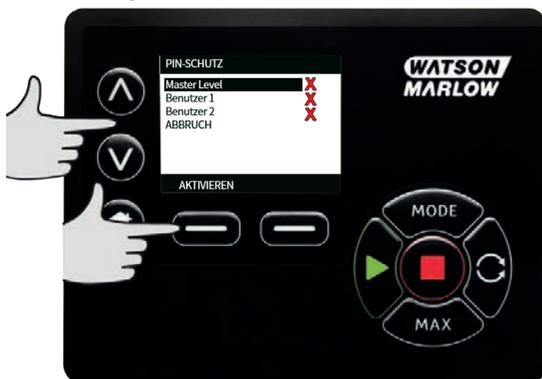
2. Über die Tasten  $\wedge$  /  $\vee$  eine vierstellige Master-PIN aus den Ziffern 0-9 eingeben. Nach Eingabe einer Ziffer auf **NÄCHSTE ZIFFER** drücken. Nach der vierten Ziffer auf **EINGABE** drücken.
