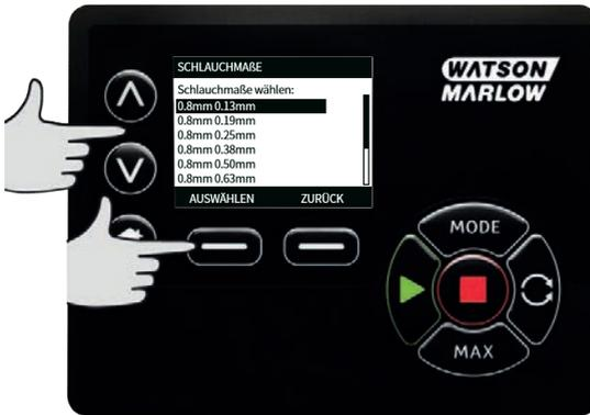
3. Bei LoadSure Schlauchelementen wird unter Schlauchgröße der Druck und der Innendurchmesser angezeigt.
