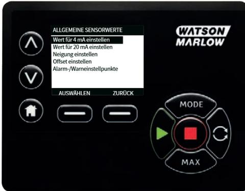
2. Wechseln Sie mit  $\wedge/\vee$  zu **Alarm-/Warneinstellpunkte**
