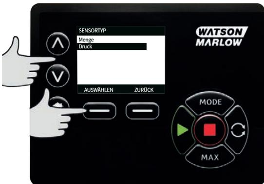
4. Eine Liste der unterstützten Reihen von Durchflusssensoren wird angezeigt. Das Beispiel in der obigen Abbildung zeigt die unterstützten Durchflusssensoren. Markieren Sie mit  $\wedge$  /  $\vee$  den gewünschten Durchflusssensor und drücken Sie **AUSWÄHLEN**.
