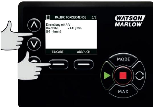
3. Auf **START** drücken, um ein Volumen an Flüssigkeit für die Kalibrierung zu pumpen.
