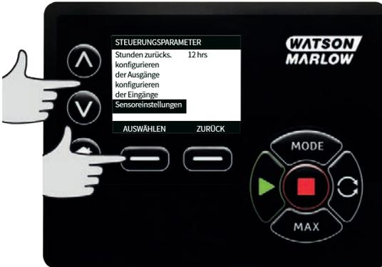
2. Markieren Sie mit  $\wedge$  /  $\vee$  die Option **Sensoren konfigurieren** und drücken Sie **AUSWÄHLEN**.
