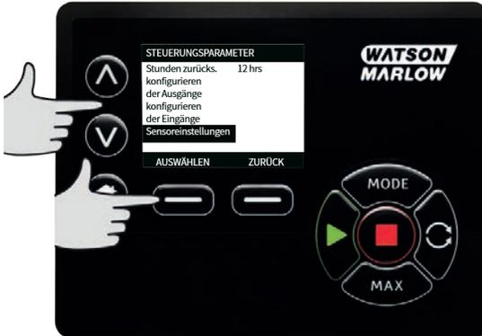
2. Markieren Sie mit  $\wedge/\vee$  **Sensoren konfigurieren** und drücken Sie **AUSWÄHLEN**.
