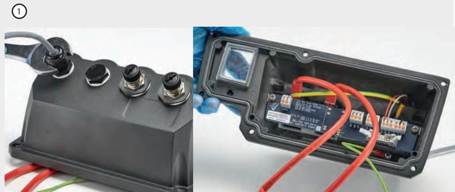
Die Abschirmung des Steuerkabels wird an die Erdungsklemme (J6) auf der Adapterplatine angeschlossen, wenn eine Kunststoffkabelverschraubung verwendet wird.
