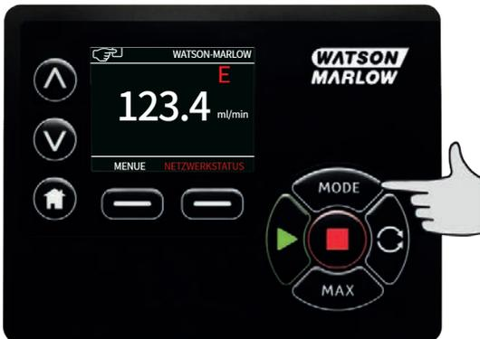
2. Markieren Sie mit  $\wedge$  /  $\vee$  **Dosieren** und drücken Sie **EINSTELLUNGEN**.
