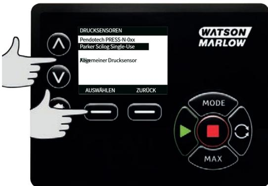
5. Der Eingang, an dem der Sensor angeschlossen ist, muss zugewiesen werden.
