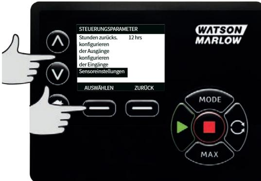
3. Markieren Sie mit  $\wedge/\vee$  **Durchfluss** oder **Druck** und drücken Sie **AUSWÄHLEN**. Damit wird der zu konfigurierende Sensortyp ausgewählt.
