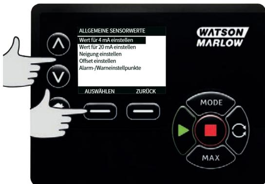
9. Ändern Sie mit  $\wedge/\vee$  den Wert, der angezeigt wird, wenn der Sensoreingang bei 4 mA liegt. Wenn Sie mit dem Wert zufrieden sind, drücken Sie **AUSWÄHLEN**.
