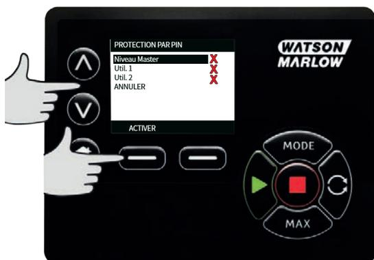
L'écran de saisie du code PIN pour l'utilisateur 1 est alors affiché. Pour configurer le code PIN Utilisateur 1 à quatre chiffres, utilisez les touches  $\wedge$  /  $\vee$  afin de sélectionner chaque chiffre compris entre 0 et 9. Une fois le chiffre désiré affiché à l'écran, appuyez sur **CHIFFRE SUIVANT**. Une fois les quatre chiffres sélectionnés, appuyez sur **ENTRÉE**.
