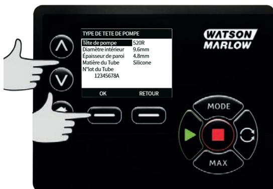
À l'aide des touches  $\wedge$  /  $\vee$ , placez la barre de sélection sur le type de tête de pompe désiré, puis appuyez sur **SÉLECTIONNER**.
