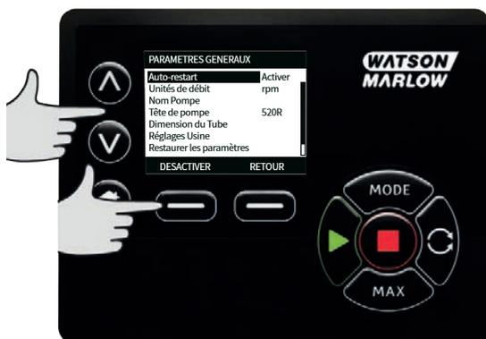
À l'aide des touches  $\wedge$  /  $\vee$ , placez la barre de sélection sur **Tête de pompe**, puis appuyez sur **SÉLECTIONNER**.
