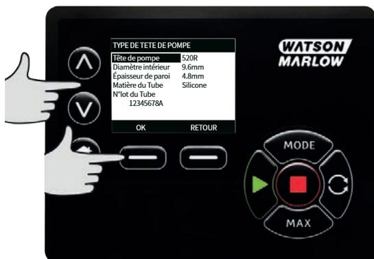
À l'aide des touches  $\wedge$  /  $\vee$ , placez la barre de sélection sur la taille de tube à utiliser, puis appuyez sur **SÉLECTIONNER**.
