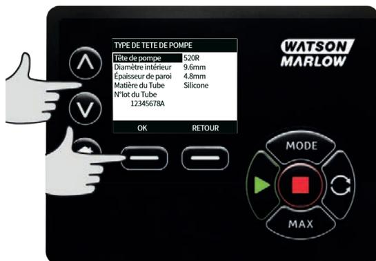
À l'aide des touches  $\wedge$ / $\vee$ , placez la barre de sélection sur le matériau du tube à utiliser, puis appuyez sur **SÉLECTIONNER**.
