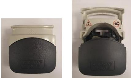
3. Stellen Sie sicher, dass die Schlauchklemmen auf die richtige Schlauchgröße eingestellt sind.
