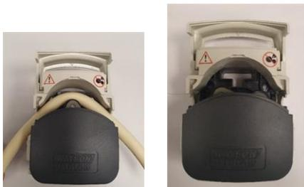
8. Schließen Sie den Klappdeckel vollständig. Damit wird der Schlauch automatisch in die richtige Lage eingespannt. Überprüfen Sie, dass sich der Schlauch an der in der Abbildung gezeigten Position befindet. Spannen Sie den Schlauch nicht noch zusätzlich.
