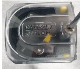
3. Entfernen Sie die Rotornabe, indem Sie den Schutzdeckel anheben und die Sicherungsschrauben entfernen.
