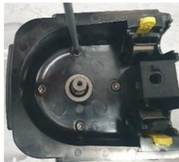
5. Nehmen Sie den alten Pumpenkopf von der Montageplatte und positionieren Sie den neuen Pumpenkopf.
