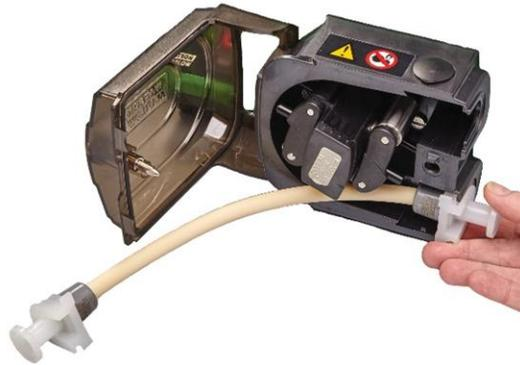
7. Rücken Sie die Rotorkupplung aus, indem Sie den gelben Kupplungsknopf an der Seite der Rotornabe ganz eindrücken und die Nabe bei gedrücktem Kupplungsknopf um einige Grad drehen. Der Rotor kann jetzt losgelöst von Getriebe und Motor eine volle Umdrehung bewegt werden. Sollte die Kupplung wieder einrasten, ehe der Schlauch ganz eingelegt worden ist, drücken Sie den Knopf nochmals und drehen Sie den Rotor um einige Grad.
