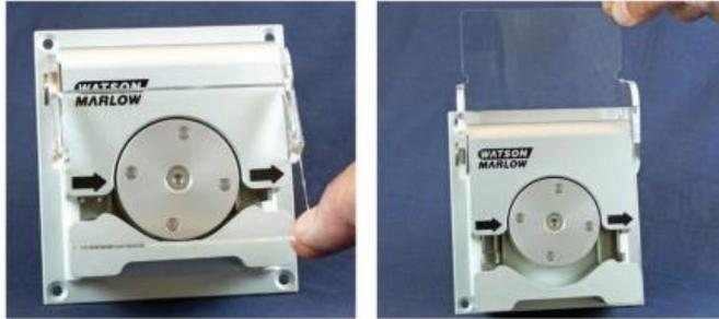
5. Stellen Sie sicher, dass die für die Schlauchklemmen passende Schlauchgröße installiert wird.
