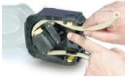
9. Die federgespannten Schlauchklemmen müssen den Schlauch fest genug halten, um zu verhindern, dass er sich im Pumpenkopf bewegt, dürfen ihn jedoch nicht zu sehr quetschen. Drehen Sie den Rotor einige Male probeweise und stellen Sie die Schieber so ein, dass sich der Schlauch nicht bewegt. In der äußeren Position hält die Klemme den Schlauch fest, in der inneren hält sie ihn locker.
