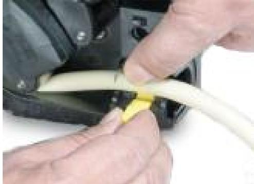
6. Rücken Sie die Rotorkupplung aus, indem Sie den gelben Kupplungsknopf an der Seite der Rotornabe ganz eindrücken und die Nabe bei gedrücktem Kupplungsknopf um einige Grad drehen. Der Rotor kann jetzt losgelöst von Getriebe und Motor eine volle Umdrehung bewegt werden. Sollte die Kupplung wieder einrasten, ehe der Schlauch ganz eingelegt worden ist, drücken Sie den Knopf nochmals und drehen Sie den Rotor um einige Grad.
