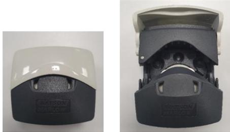
5. Stellen Sie sicher, dass die Schlauchklemmen auf die richtige Schlauchgröße eingestellt sind.
