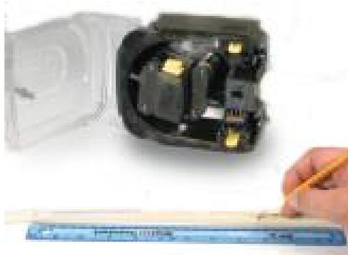
14. Öffnen Sie die untere federgespannte Schlauchklemme und setzen Sie den Schlauch so ein, dass die erste 225-mm-Längenmarkierung mit der Innenfläche des federgespannten Teils der Schlauchklemme auf einer Linie liegt. Schließen Sie die Klemme.
