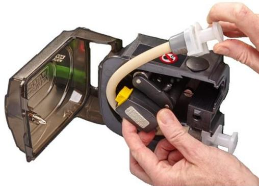
7. Legen Sie das andere Verbindende des Elements in den oberen Teil des Gehäuses ein. Stellen Sie sicher, dass das Schlauchelement nicht verdreht ist und mittig zwischen den Rollen liegt.
