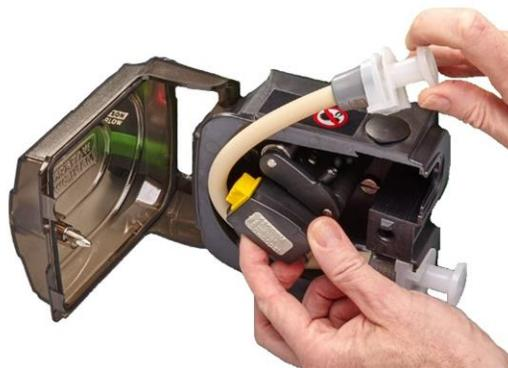
9. Legen Sie das andere Verbindende des Elements in den oberen Teil des Gehäuses ein. Stellen Sie sicher, dass das Schlauchelement nicht verdreht ist und mittig zwischen den Rollen liegt.
