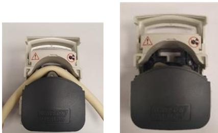
6. Schließen Sie den Klappdeckel vollständig. Damit wird der Schlauch automatisch in die richtige Lage eingespannt.
