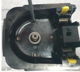
7. Bringen Sie die Rotornabe an, indem Sie den Schutzdeckel anheben und die Sicherungsschrauben anbringen.
