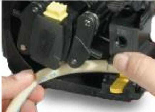
17. Achten Sie darauf, dass die zweite 225-mm-Markierung an der Innenkante der oberen Schlauchklemme anliegt. Öffnen Sie die obere Schlauchfederklemme und setzen Sie den Schlauch darin ein. Achten Sie darauf, dass der Schlauch nicht verdreht ist und mittig zwischen den Schlauchführungsrollen liegt. Schließen Sie die Klemme.
