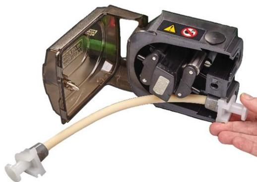
5. Rücken Sie die Rotorkupplung aus, indem Sie den gelben Kupplungsknopf an der Seite der Rotornabe ganz eindrücken und die Nabe bei gedrücktem Kupplungsknopf um einige Grad drehen. Der Rotor kann jetzt losgelöst von Getriebe und Motor eine volle Umdrehung bewegt werden. Sollte die Kupplung wieder einrasten, ehe der Schlauch ganz eingelegt worden ist, drücken Sie den Knopf nochmals und drehen Sie den Rotor um einige Grad.
