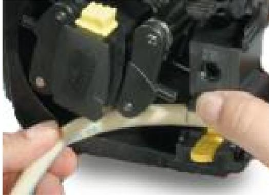
8. Achten Sie darauf, dass die zweite 225-mm-Markierung an der Innenkante der oberen Schlauchklemme anliegt. Öffnen Sie die obere Schlauchfederklemme und setzen Sie den Schlauch darin ein. Achten Sie darauf, dass der Schlauch nicht verdreht ist und mittig zwischen den Schlauchführungsrollen liegt. Schließen Sie die Klemme.
