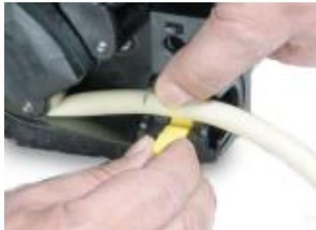
15. Rücken Sie die Rotorkupplung aus, indem Sie den gelben Kupplungsknopf an der Seite der Rotornabe ganz eindrücken und die Nabe bei gedrücktem Kupplungsknopf um einige Grad drehen. Der Rotor kann jetzt losgelöst von Getriebe und Motor eine volle Umdrehung bewegt werden. Sollte die Kupplung wieder einrasten, ehe der Schlauch ganz eingelegt worden ist, drücken Sie den Knopf nochmals und drehen Sie den Rotor um einige Grad.
