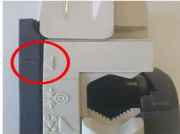
4. Drehen Sie das Einstellrädchen an der Klemmenbaugruppe, um die erforderliche Wandstärke und den gewünschten Innendurchmesser einzustellen. Durch Drehen gegen den Uhrzeigersinn wird das Element mit der Anzeige der Wandstärke angehoben. Drehen Sie das Rädchen im Uhrzeigersinn, um das Element nach unten zu bewegen.
