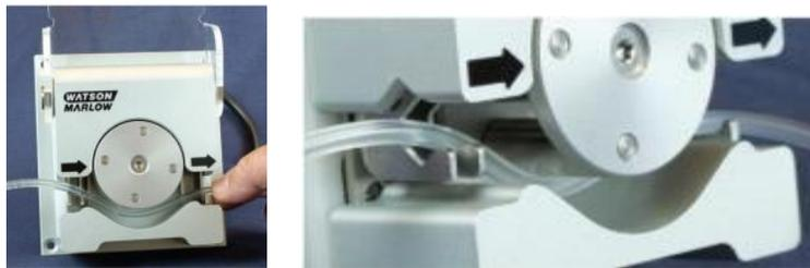
6. Schließen Sie den Klappdeckel vollständig. Damit wird der Schlauch automatisch in die richtige Lage eingespannt.
