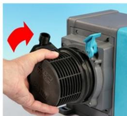
Pour dégager la tête de pompe de l'entraînement, tournez la tête de pompe d'environ 38 cm dans le sens des aiguilles d'une montre.
