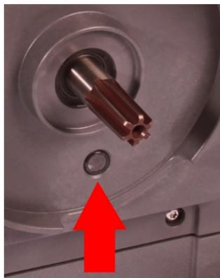
Vérifiez que le détecteur de fuite et l'arbre d'entraînement sont propres et exempts de tout produit chimique de process. Si un produit chimique est détecté, mettez la pompe hors service et contactez votre représentant Watson-Marlow local pour obtenir des conseils.
