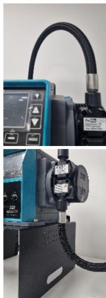
Vérifiez la longueur totale et le raccordement du flexible pour vous assurer qu'il n'y a pas de torsion, de coude ou de frottement du flexible contre lui-même (par exemple lorsqu'il forme une boucle) ou contre une autre surface (par exemple : le bord de l'orifice d'accès ou une tablette).
