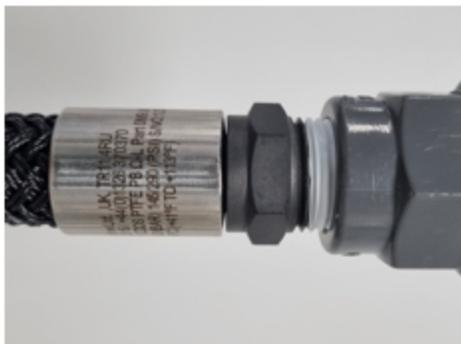
4. Vérifiez que le joint de l'orifice de la tête de pompe est en place comme l'indique l'image et qu'il n'est pas endommagé.
