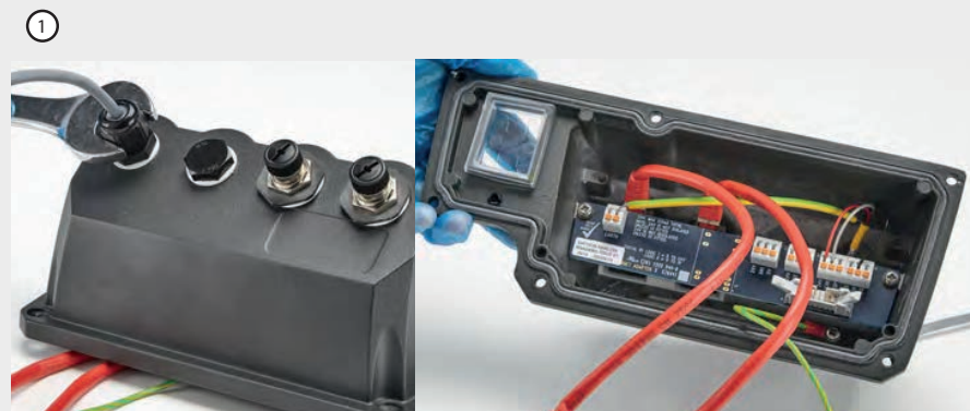
Figura 10 - Puesta a tierra de los cables de control en en el módulo NEMA PROFINET®
