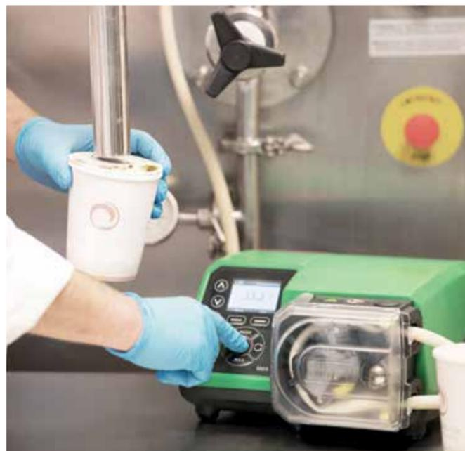
Les pompes péristaltiques peuvent manipuler des fluides agressifs et sensibles au cisaillement. Le fluide acheminé est entièrement confiné à l'intérieur du tube et en total isolement, n'entrant en contact avec aucun autre élément, et assurant l'absence totale de contamination croisée.
