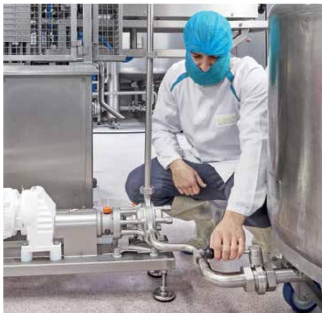
La pompe Certa MasoSine surpasse les pompes à lobes dans les applications critiques de l'industrie agroalimentaire. La conception à rotor sinusoïdal de nos pompes MasoSine assure un faible cisaillement et un pompage en douceur qui permettent le transfert des aliments délicats sans risque de dégradation.
