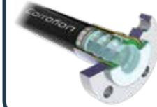
CorroflonのPTFEライナには、流量制限を最低限に抑える浅い回旋があり、更に、外部回旋の補強ファイヤにより完全な密封性とホースのねじれ耐性を実現しています。
