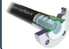
Corroflon의 PTFE 라이너에는 유량 제한을 최소화하는 헬로우 컨볼루션(shallow convolution)이 있고 외부 컨볼루션의 외부 보강선이 전체 진공 저항과 꼬임 저항을 제공합니다.
